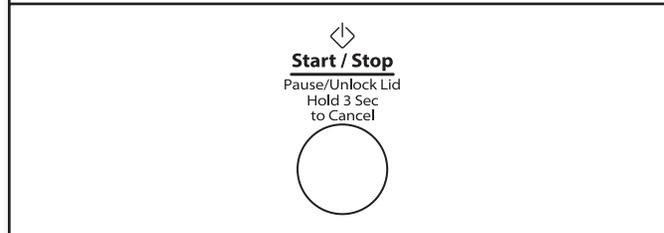
Appuyer sur le bouton Start/Stop/Pause/Unlock Lid (mise en marche/arrêt/pause/déverrouillage couvercle) pour démarrer le programme de lavage. Une fois le programme terminé, le témoin lumineux Cycle Complete (programme terminé) s'allume. Retirer rapidement les vêtements une fois le programme terminé pour empêcher la formation d'odeurs, réduire le froissement et empêcher les crochets métalliques, fermetures à glissière et boutons-pression de rouiller.
