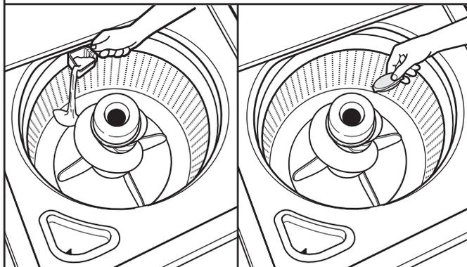
Verser une mesure de détergent (poudre ou liquide) ou un sachet de lessive à dose unique dans le panier.
