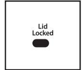
Si l'on doit ouvrir le couvercle, appuyer sur START/STOP/PAUSE/UNLOCK LID (MISE EN MARCHÉ/ARRÊT/PAUSE/DÉVERROUILLAGE COUVERCLE). Le couvercle se déverrouille une fois que le mouvement du lave-linge a cessé. Il se peut que cela prenne plusieurs minutes si le lave-linge essore la charge à grande vitesse. Appuyer de nouveau sur START/STOP/PAUSE/UNLOCK LID (MISE EN MARCHÉ/ARRÊT/PAUSE/DÉVERROUILLAGE COUVERCLE) pour poursuivre le programme.
