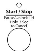
Premere START/STOP/PAUSE/UNLOCK LID (Avvio/Arresto/Pausa/Sblocco sportello) per avviare il ciclo di lavaggio. Al termine del ciclo, si accende la spia Cycle Complete (ciclo completato). Rimuovere prontamente i capi al termine del ciclo per evitare la formazione di odori, lo stropicciamento e la formazione di ruggine su ganci, zip e bottoni a pressione.
