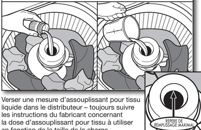
Verser une mesure d'assouplissant pour tissu liquide dans le distributeur – toujours suivre les instructions du fabricant concernant la dose d'assouplissant pour tissu à utiliser en fonction de la taille de la charge.
