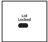
Se è necessario aprire lo sportello, premere START/STOP/PAUSE/UNLOCK LID (Avvio/Arresto/Pausa/Sblocco sportello). Lo sportello si sblocca quando il movimento della lavatrice si arresta. Possono essere necessari alcuni minuti se era in corso la centrifuga ad alta velocità. Premere nuovamente START/STOP/PAUSE/UNLOCK LID (Avvio/Arresto/Pausa/Sblocco sportello) per far riprendere il ciclo.
