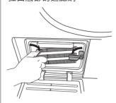
使用流水清潔底部過濾網。擦去灰塵和絨毛。
