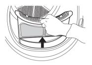
按壓按鈕打開機門過濾器,清除裡面的塵埃雜質。 關閉過濾器,並以正確方向重新裝上,使其完全置於過濾室。
