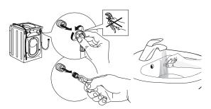
**4.** 裝回濾網並將進水喉擰回機上。不要使用其他工具來連接進水喉。打開水龍頭並確認各連接位均完全不漏水。
