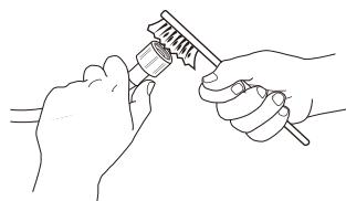
3. 現在用手擰下洗衣機背面的進水軟管。用鉗子從洗衣機背面的閥門中拔出網狀過濾器並仔細清潔。
