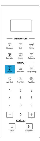
此功能適用於軟化和解凍食物,輸入食物的重量。選擇食物類別後,微波爐會自動計算出解凍食物需要的溫度及時間以提供最佳烹飪結果。
