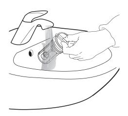
6. 插入濾網塞並裝回底座:將濾網塞回原位,然後按順時針方向轉緊到最深位置。濾網手柄必須處於垂直位置。可以倒入約1公升的水於洗滌盒測試濾網是否已轉緊。然後裝回底座。
