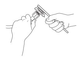
**3.** 拆下洗衣乾衣機後方的進水喉。用通用鉗子將濾網從洗衣乾衣機接頭上拆下並清潔。
