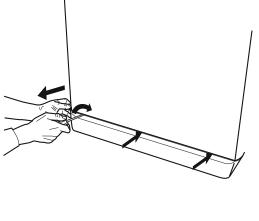
3. 排走積水:逆時針轉動濾網而不用拆 開濾網,並緩慢打開直至排走全部 水。當該容器是滿水,將濾網按順時 針方向轉緊。清空容器,重複這個步 驟,直到水全部流出。
