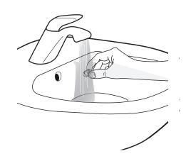
**4.** 裝回濾網並將進水喉擰回機上。不要使用工具來連接進水喉。打開水龍頭並確認各連接位均完全不漏水。
